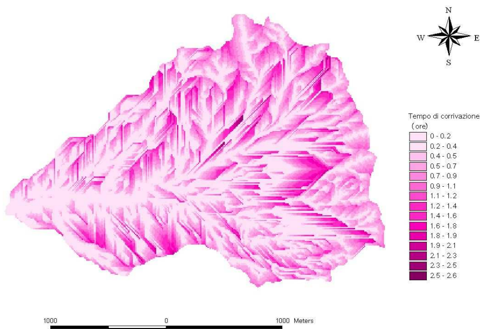
Fig. 9 - Mappa dei tempi di corrivazione (in ore) del bacino del Missiaga chiuso a quota 1096 m s.l.m.
